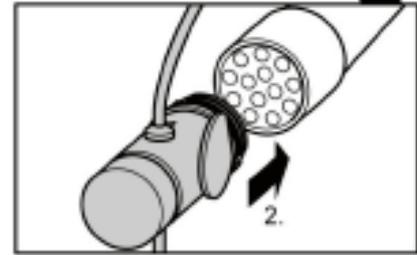
Entrambe le spine sono in un alloggiamento. Si prega di coprire la spina che non si utilizza con la copertura in dotazione.
