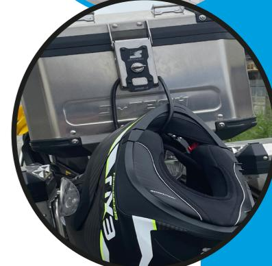
La nuova versione GSA monta sulla piastra originale BMW GS ADVENTURE ed è a sgancio rapido. Il sistema di aggancio funziona tramite una leva posizionata nella parte inferiore del bauletto ed un perno che dovrà essere ruotato per  $\frac{1}{4}$  di giro sempre posizionato all'interno.
