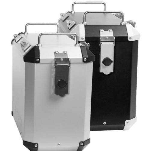
La linea Raid : la prima linea del mondo Mytech, un must have tutto alluminio, una garanzia. La linea Raid è interamente in alluminio compresi gli angolari ed è verniciata a polvere per garantire resistenza a graffi e corrosione. Le nostre valigie sono saldate internamente per garantire l'impermeabilità.
