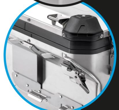
La nuova versione GSA monta sui telai originali BMW GS ADVENTURE ed è a sgancio rapido. Il sistema di aggancio funziona tramite una leva posizionata nella parte posteriore della valigia ed un perno che dovrà essere ruotato per  $\frac{1}{4}$  di giro posizionato all'interno della valigia.
